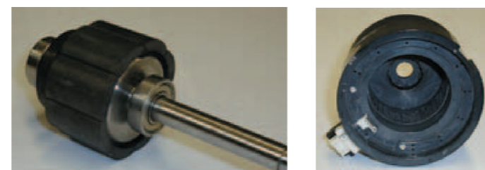
DC FAN MOTOR STRUCTURE
